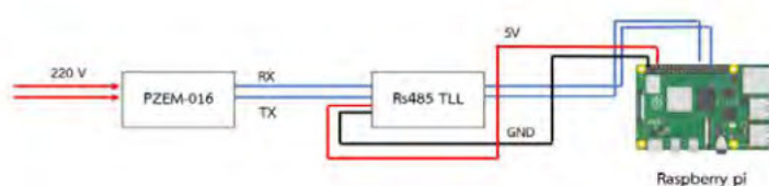
ภาพที่ 1 การออกแบบการเชื่อมต่อ Hardware ระบบติดตามการใช้พลังงาน
