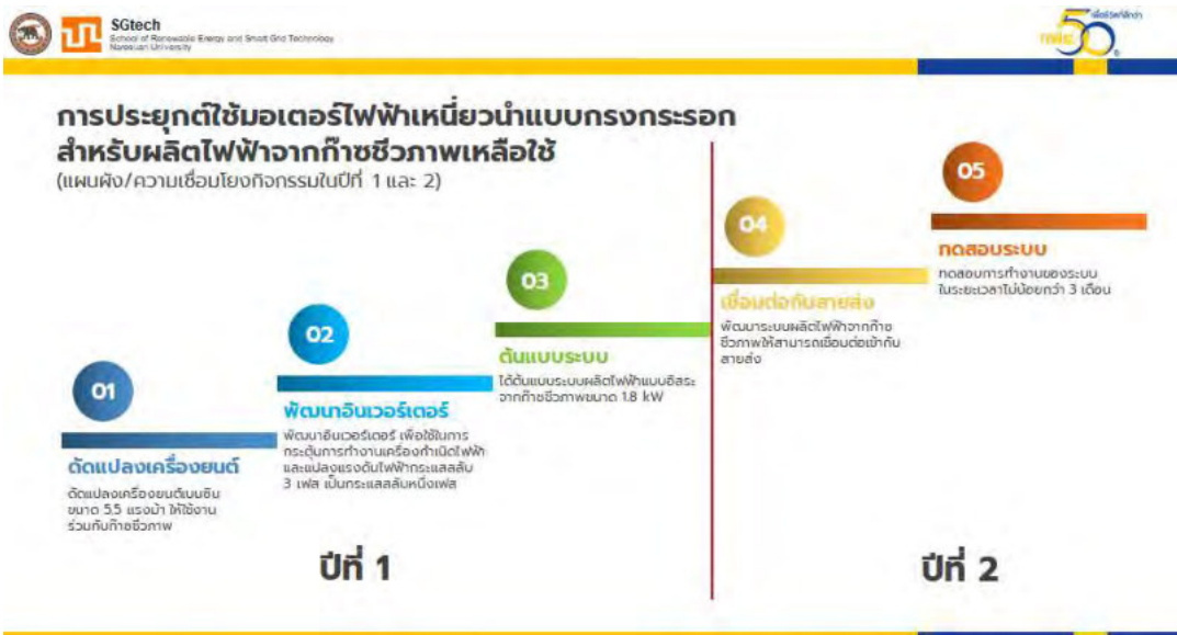
ภาพที่ 6 การประยุกต์ใช้มอเตอร์ไฟฟ้าเหนี่ยวนำแบบกรงกระรอกสำหรับผลิตไฟฟ้าจากก๊าซชีวภาพเหลือใช้
