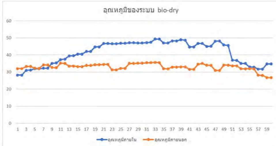
ภาพที่ 3 แสดงอุณหภูมิภายในระบบ Biodry เปรียบเทียบกับภายนอกระบบ
