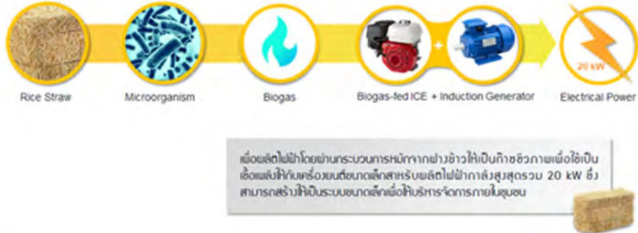
ภาพที่ 5 เป้าหมายในการพัฒนากระบวนการผลิตก๊าซชีวภาพต้นแบบจากฟางข้าวโดยใช้จุลินทรีย์เร่ง กระบวนการเพื่อยกระดับการผลิตไฟฟ้าและความร้อนสำหรับชุมชน
